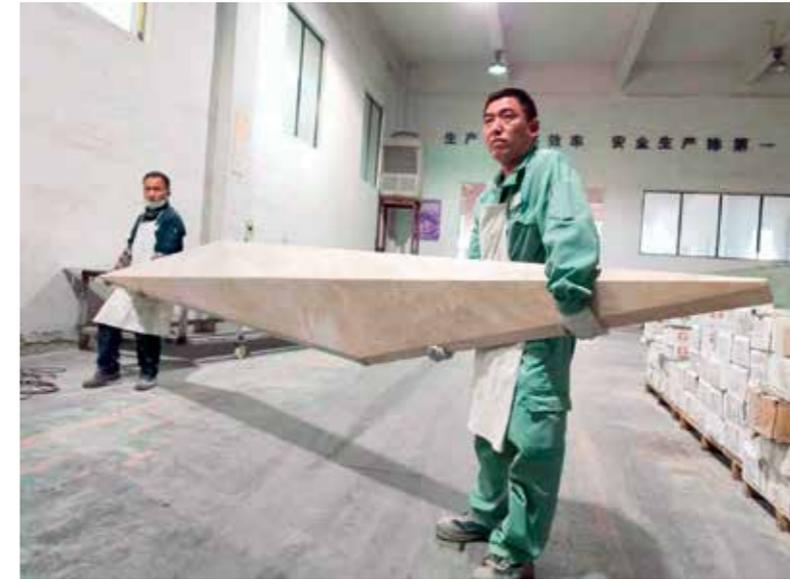
Fassadenelement bei der Fertigung
