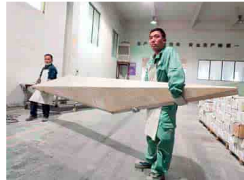
Fassadenelement bei der Fertigung Producing a façade module
