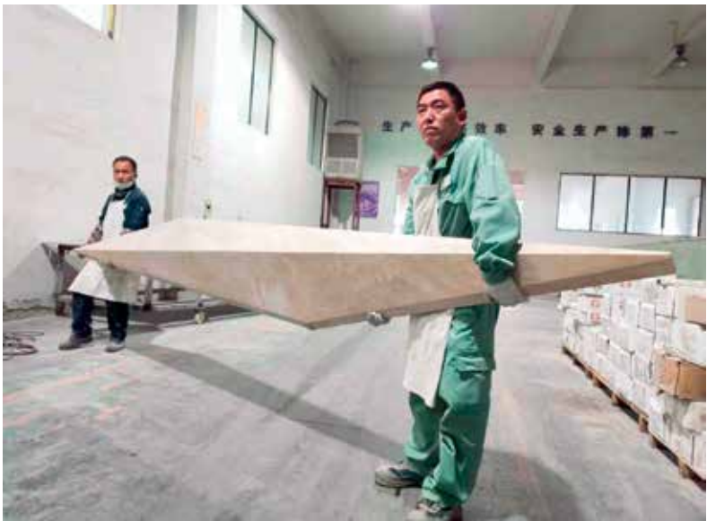
制造过程中的立面构件 Producing a façade module
